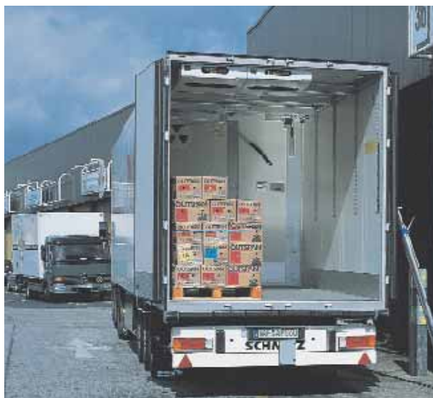
Rys. 14 » Dobra izolacja i wytrzymałość na obciążenia: zastosowanie płyt z rdzeniem STYROFOAM w nadwoziu samochodu chłodni.
