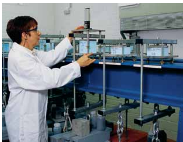
Rys. 10 » Laboratorium - próba pełzania materiału STYROFOAM
