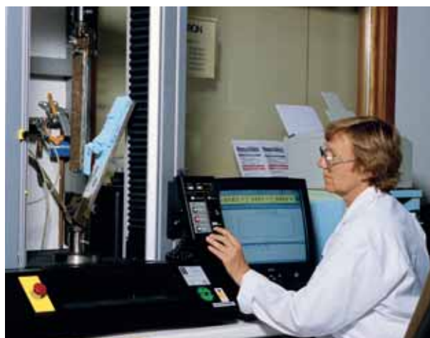
Rys. 11 » STYROFOAM - próba ścinania
